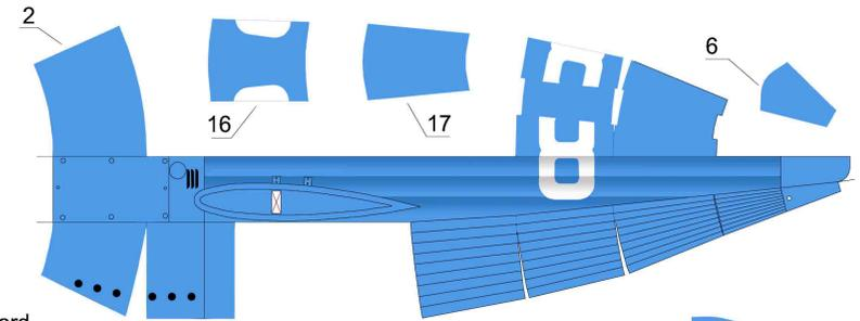
avant collage sur la structure, marquer les plis et préformer les parties arrondies de 2 et 3
