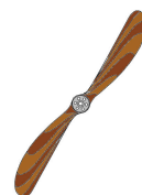
H hélice CHAUVIERE rotation horaire vue place pilote
