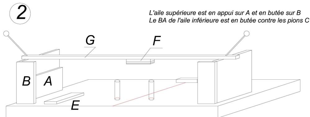
L'aile supérieure est en appui sur A et en butée sur B
