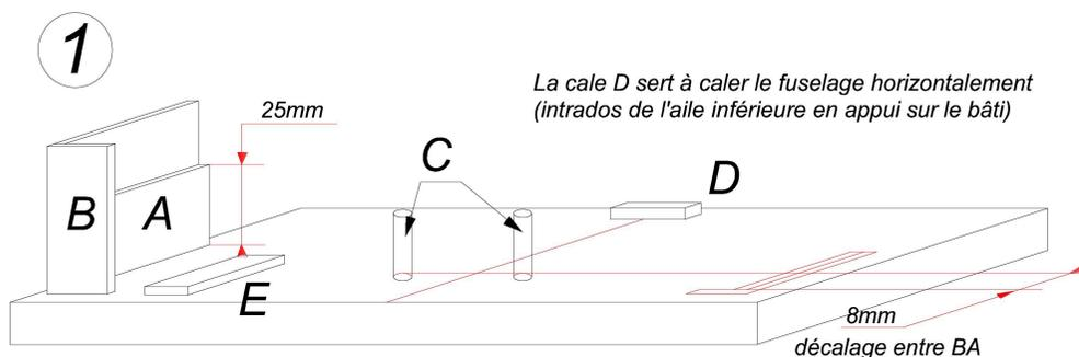
La cale D sert à caler le fuselage horizontalement (intrados de l'aile inférieure en appui sur le bâti)
